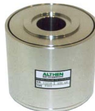
Bei den Kraftaufnehmern der Serie ALF203 handelt es sich um robuste, äußerst kompakte, aber dennoch präzise messende Aufnehmer für große Kräfte. Das als Hohlkörper ausgebildete Messelement ist mit 8 Miniatur-Metallfolien-Dehnmessstreifen ausgestattet, die als 2 DMS-Vollbrücken verschaltet sind. Durch diese Anordnung ist der Geber relativ unempfindlich gegen Seitenkräfte oder nichtzentrische Belastungen.
