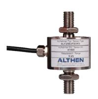
Bei den Wägezellen/Kraftaufnehmern der Serie ALF256 handelt es sich um eine Serie von äußerst kompakten, sehr präzisen, abgedichteten (IP65, optional IP67) Aufnehmern, die vor allem für den einfachen Aufbau von Wägesystemen entwickelt wurden. In einer Ausführung als "Lastfuß" kann man die Geber direkt unter Plattformen, Rahmen, Silos und Mischer usw. schrauben und erhält eine einfache, sehr genaue Wägeeinrichtung.
