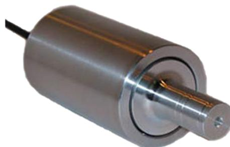
Bei den Kraftaufnehmern der Serie ALF325 handelt es sich um präzise messende Aufnehmer für die Messung der Bahnspannung. Die Bauform des Aufnehmers mit einer Abflachung und integrierten Bohrungen ermöglicht eine präzise und flexible Ausrichtung des Aufnehmers in der Maschine. Dadurch können Fehler durch unpräzises Einrichten vermieden werden.
