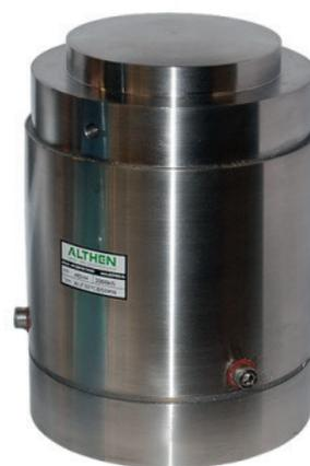
Bei den Kraftaufnehmern der Serie ALF327 handelt es sich um Druck-Kraftaufnehmer für große Kräfte. Der Kraftaufnehmer ist mechanisch groß dimensioniert, um die Flächenbelastung auf der Kontaktfläche auch bei großen Kräften möglichst gering zu halten. Die Aufnehmer sind aus rostfreiem Stahl hergestellt und werden dicht nach IP67 geliefert. Sie sind für den Einsatz in rauer, industrieller Umgebung geeignet.
