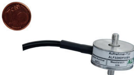
Bei dem Kraftaufnehmer ALF328 handelt es sich um einen universellen Kraftsensor zum Messen von kleinen axialen Kräften mit quantifizierter Fremdlast- und Momentenunterdrückung. Durch seine Dehnungs-messbrücke mit dem hohen Widerstand von 5.000 Ohm eignet sich der Kraftaufnehmer besonders für batteriebetriebene Anwendungen z. B. mit einem Laptop-Computer mit DSC-USB-Kraftaufnehmer-Digitalisierer oder der mobilen Messanzeige TR150.
