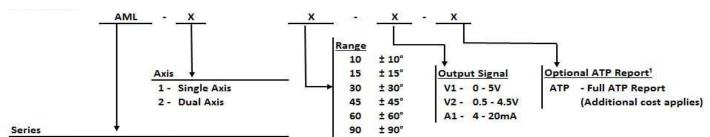
AML - Analog MEMS Inclinometer
