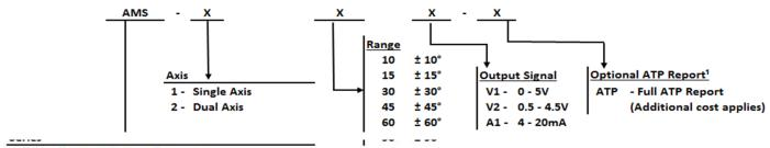
AMS - Analog MEMS Inclinometer
