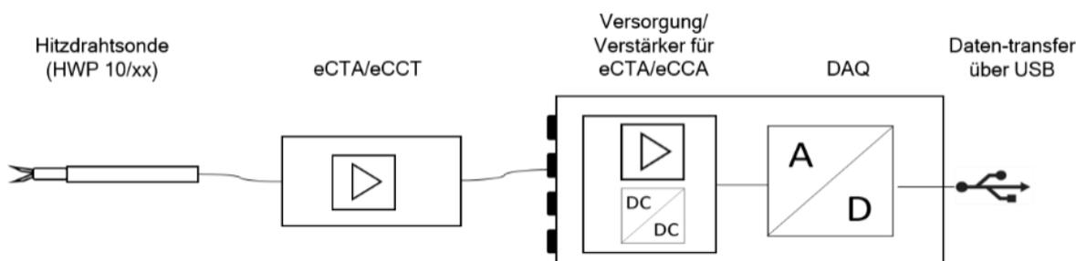
Die Messkette des Hitzdrahtsensors besteht aus vier Komponenten: Hitzdrahtsensor → Hitzdrahtbrücke → Versorgungs- und Signalkonditionierungseinheit → A/D-Wandlung.
