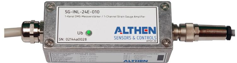
Der 1-Kanal-Inline-DMS-Messverstärker SG-INL im robusten Aluminium-Gehäuse (IP20) ermöglicht die Speisung und Signalverstärkung von einem DMS-Messwertaufnehmer. Es können beliebige DMS-Messwertaufnehmer mit einem DMS-Vollbrückenwiderstand größer als 300 Ohm angeschlossen werden. Die Beschaltung des Messwertaufnehmers erfolgt in 4-Leitertechnik.
