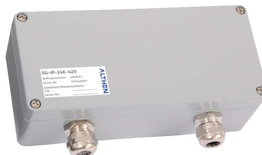
Der beschriebene 1-Kanal-DMS-Messverstärker im EMV-Aluminium-Druckgussgehäuse ermöglicht die Speisung und Signalverstärkung eines DMS-Messwertempfängers. Die Versorgungsspannung und der Analogausgang sind galvanisch voneinander getrennt. Es können beliebige DMS-Messwertempfänger mit DMS-Vollbrücken größer als 300 Ohm angeschlossen werden. Die Beschaltung erfolgt in 4-Leitertechnik. Zur weiteren Auswertung stehen je nach Ausführung Norm-Analogausgangssignale zur Verfügung.
