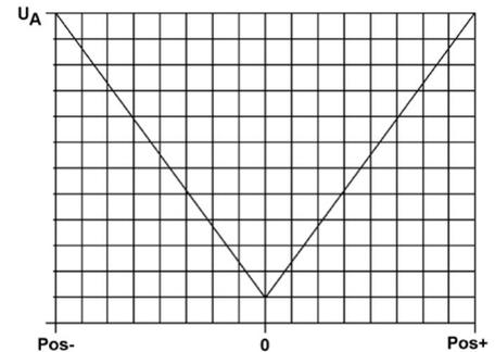
Abb.0: Ausgangssignal (AC) über dem Messbereich
