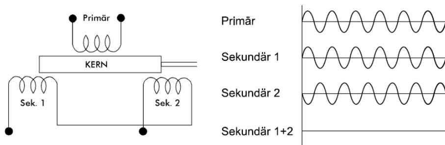
Abb.1: Nullpunkt-Signal LVDT-Wegaufnehmer / Wegtaster
