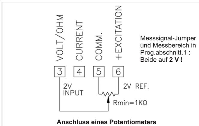
**Bild 7.6:** Anschlussbeispiel 4: Potentiometer
