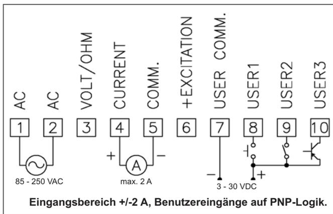
**Bild 7.4:** Anschlussbeispiel 2: Stromsignal
