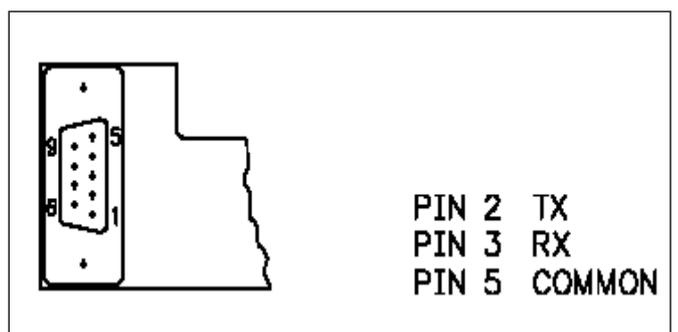
Bild 1.6: RS232-Schnittstelle **PAXCDC2C**
