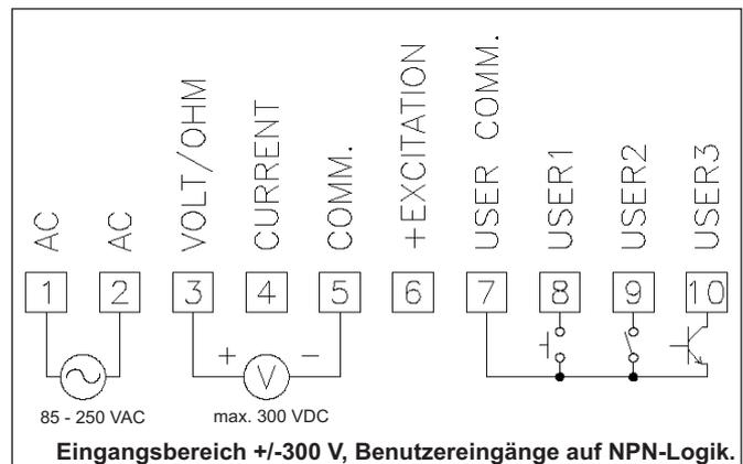
Bild 7.3: Anschlussbeispiel 1: Spannungssignal
