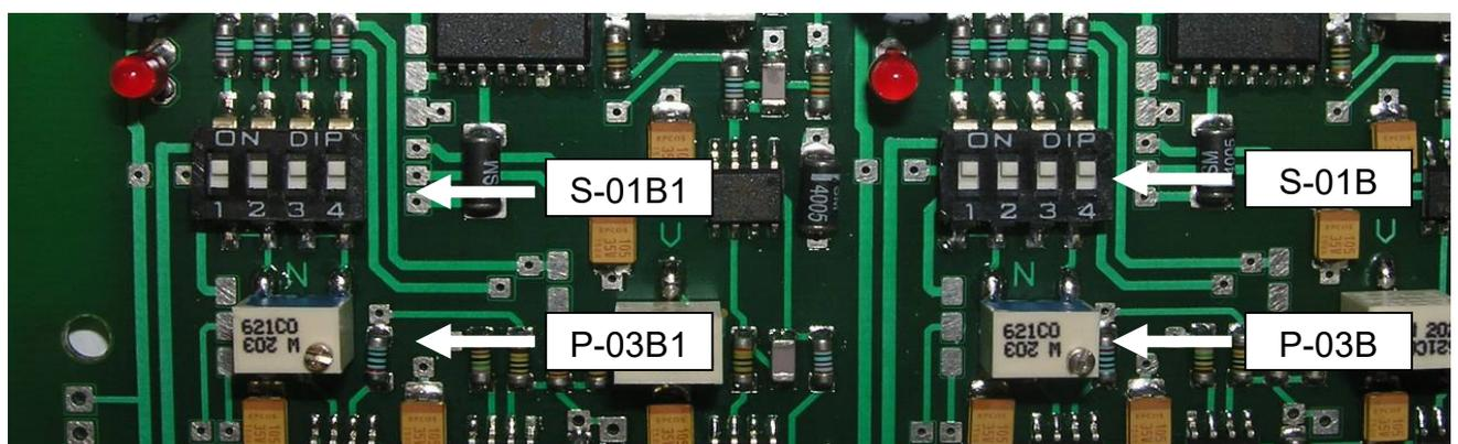
Abb.2: Kalibrierpotentiometer / DIP-Schalter N-Regelbereich
