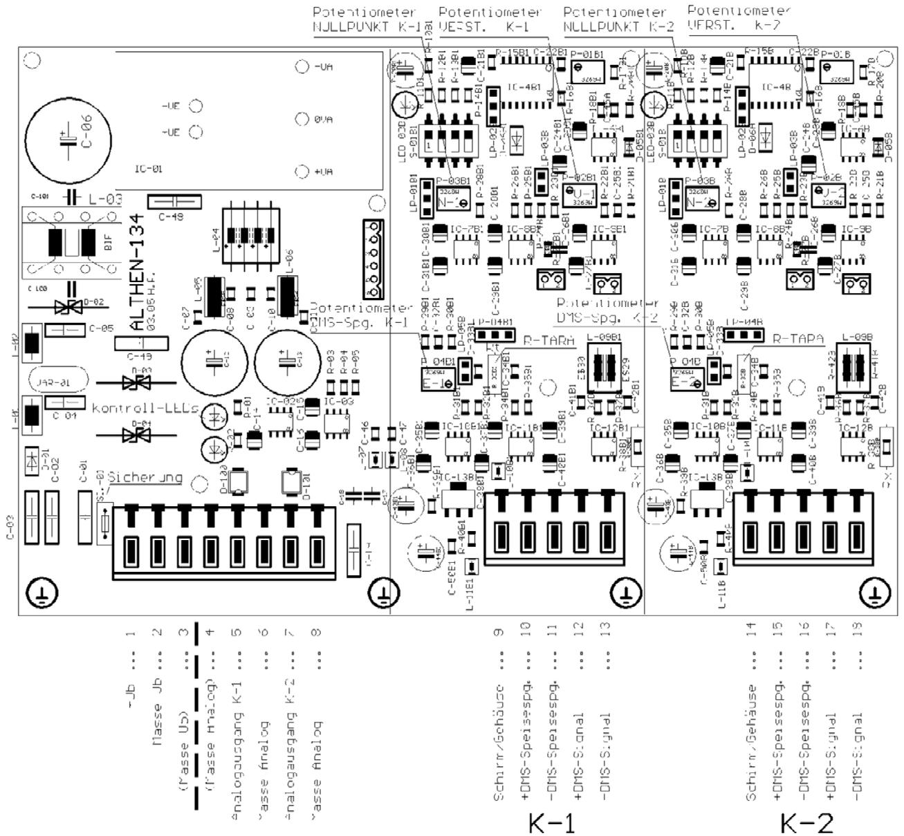
Abb.4: Bauteillageplan zeigt Platine des 2-Kanal Messverstärkers SG-2K-IP-12E/24E-xxx
