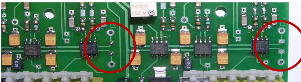
Abb.3: Verstärkungsbestimmende Widerstände für Kanal 1 und 2
