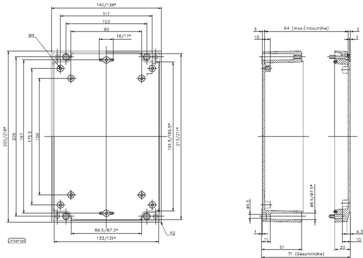
Abb.5: Gehäuse des 2-Kanal Messverstärkers SG-2K-IP-12E/24E-xxx
