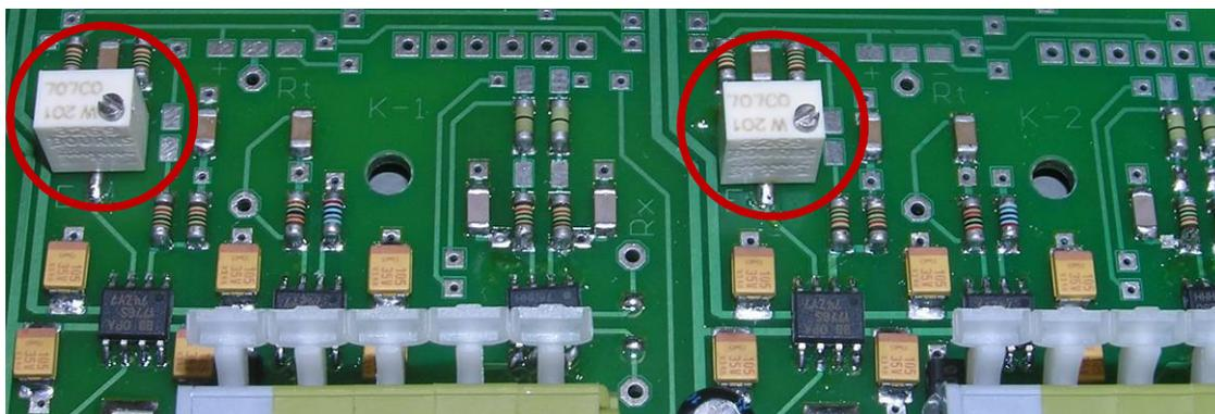
Abb.1: Lötunkte sowie Potentiometer für DMS-Speisespannung
