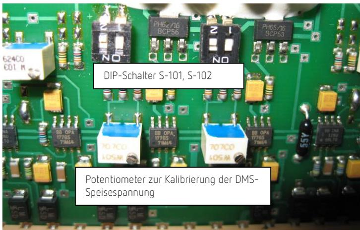
Die DMS-Speisespannung kann über zwei 2-polige DIP-Schalter auf der unteren Platine (Althen 73) gewählt und mit Hilfe von 2 Potentiometern auf der gleichen Platine genau eingestellt werden.
