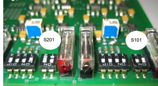
Abb.5: DIP-Schalter S-x01 Tiefpass-Filter
