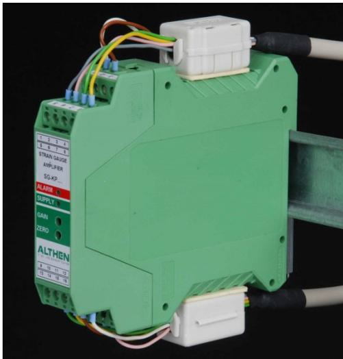
Bei der Ausführung der Erdung ist auf eine HF-konforme Ausführung der Erdung zu achten (möglichst kurz, mit großem Leitungsquerschnitt). Eventuelle leitungsgebundene Störungen sollten möglichst nahe am Kabelende (Auswerteeinheit) durch geeignete Maßnahmen abgeblockt werden.
